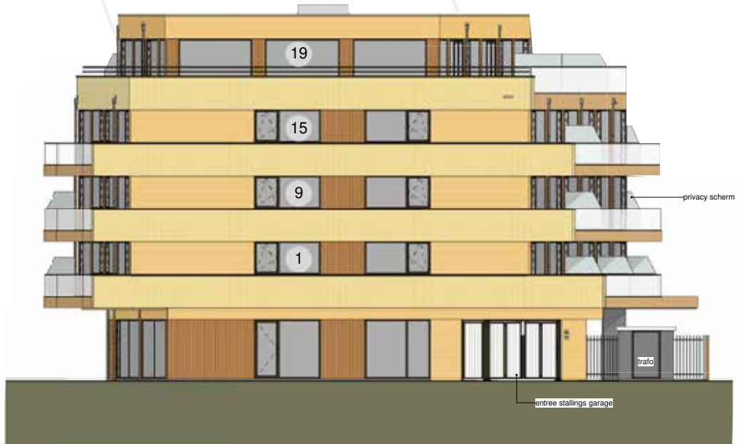
Rechterzijgevel (Dijkweg) geluidbelaste gevel
